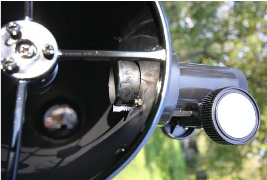
Композитный реечный фокусер с большими ручками очень удобен в работе.
