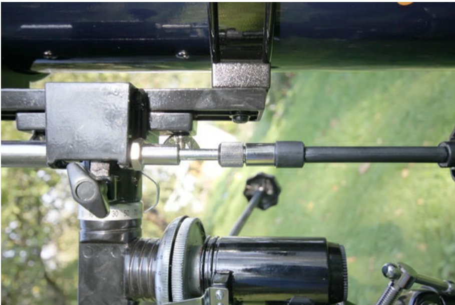
Ручки управления движением телескопа имеют шпильковый разъем, расположенный на корпусе червячной передачи.
