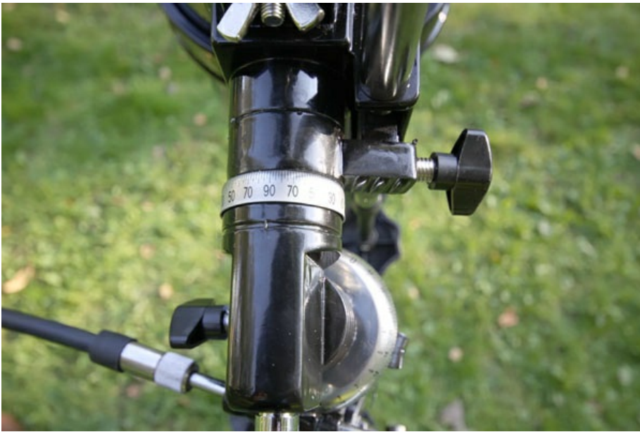
Сама труба крепится двумя гайками к основанию оси склонений.
