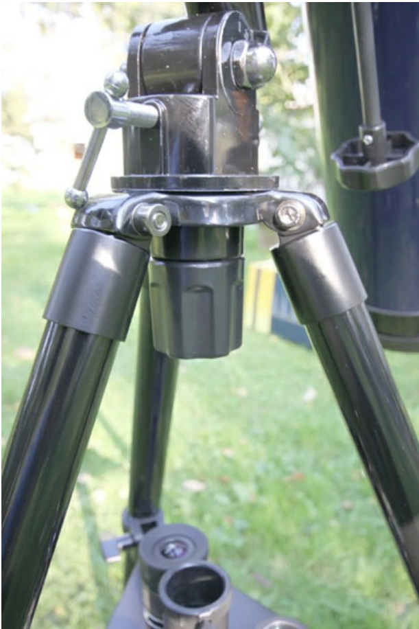
Тренога у телескопа двухсекционная, выдвигаемая, регулируется под рост наблюдателя.
