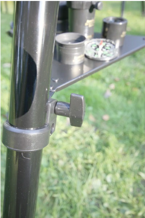
Монтировка устанавливается на треногу и крепится большой фигурной гайкой.
