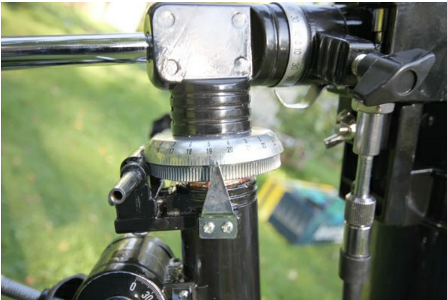
Для выставления полярной оси есть градуировочный круг, по которому удобно выставлять точное направление на полюс.
