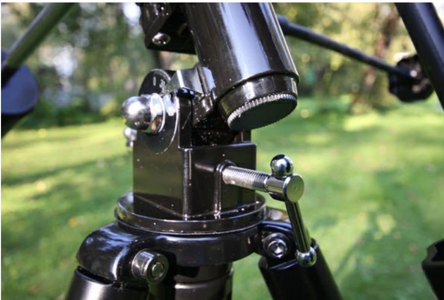
Установка полярной оси осуществляется парой винтов, расположенных на корпусе монтировки.
