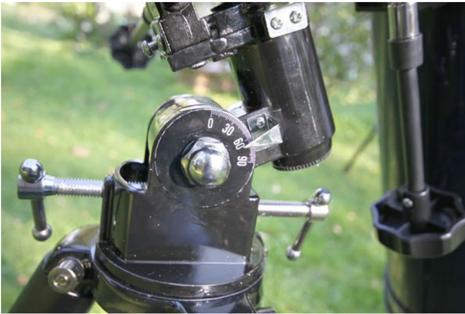
Установка полярной оси осуществляется парой винтов, расположенных на корпусе монтировки.
