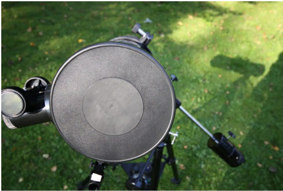
Оправа главного зеркала и паук представляют собой литые конструкции, вставляющиеся в трубу. Таким образом увеличивается жесткость самой трубы. На пауке расположены три винта для юстировки вторичного зеркала телескопа.
