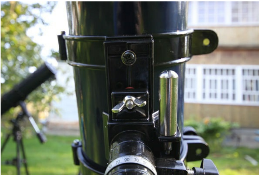
Ручки управления движением телескопа имеют шпильковый разъем, расположенный на корпусе червячной передачи.
