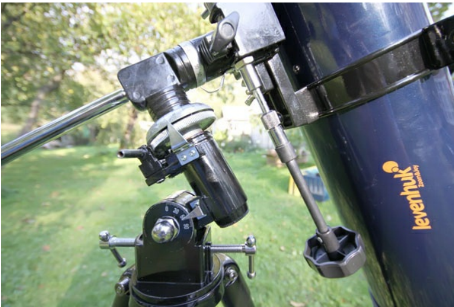
Для удобства нахождения объектов монтировка снабжена координатными кругами.
