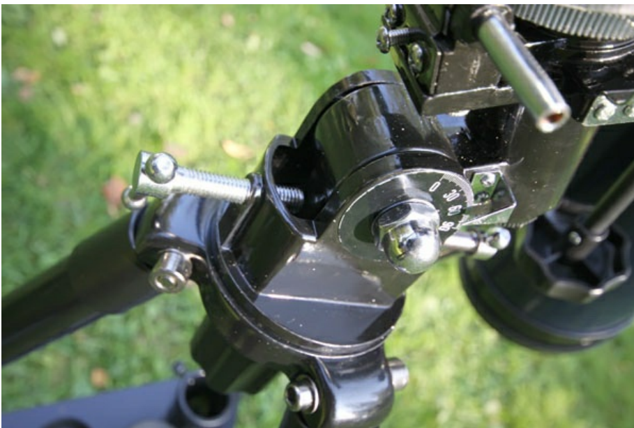
Винт фиксации оси склонений зажимайте не сильно и только после того, как вы правильно сбалансировали трубу телескопа.
